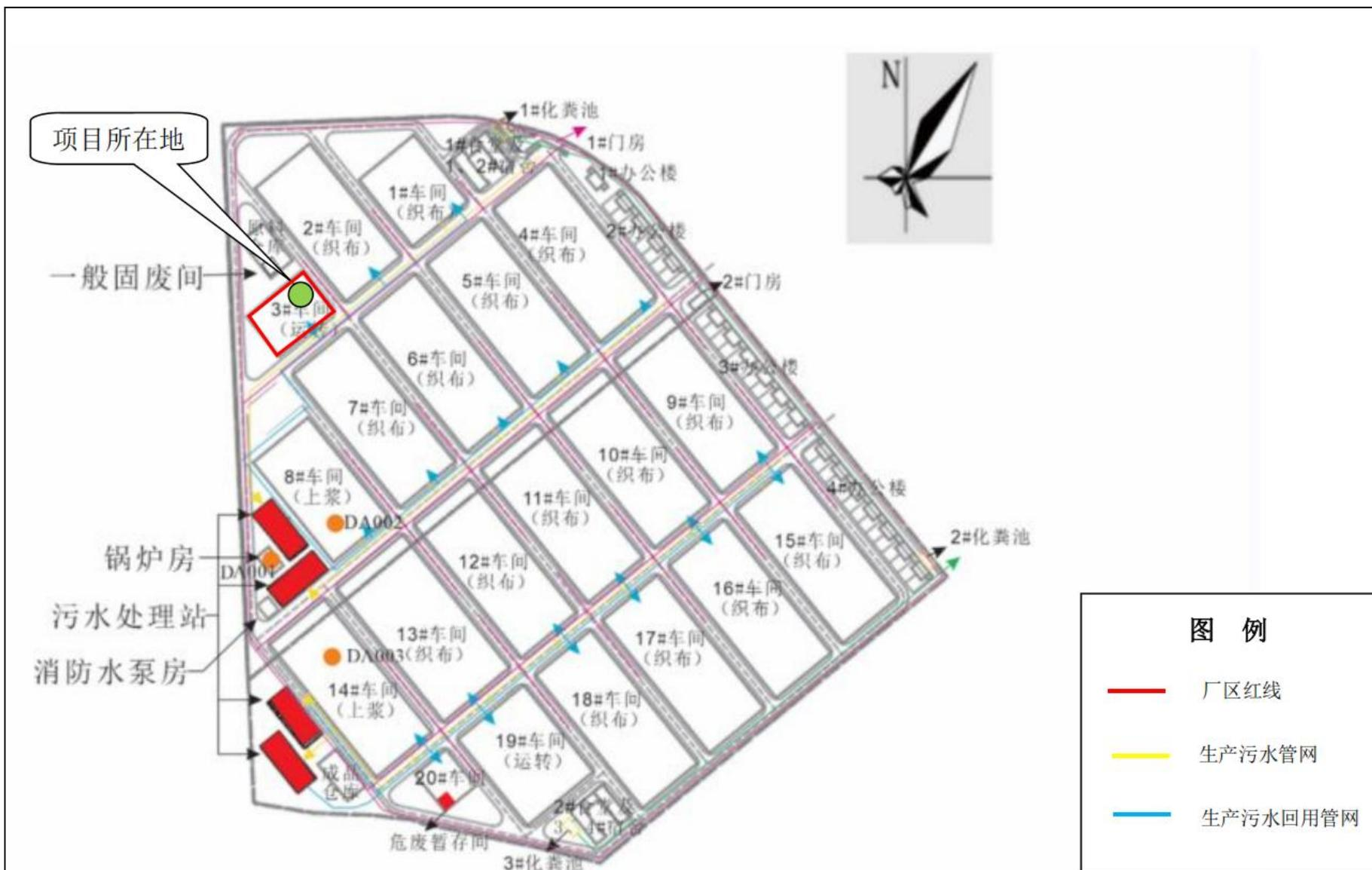
附图6 项目位于园区平面布置图及回用水管网布置图
